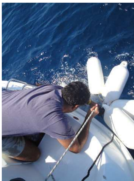
Las defensas convencionales como elemento de flotación resultaron ineficaces.
